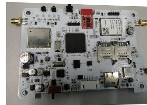
NB-IoT 独立测试设备由 lierda 生产。它可以根据预定义的流量模型假设自动发送和接收数据。该工具可以安装在现场以模拟 IoT 设备, 如水表, 停车传感器等。设备内的电池可以保持工具运行至少 1 个月。通过自动执行预定义的测试用例, 并在服务器端获取报告, 开发人员可以评估每个位置区的用户体验。
