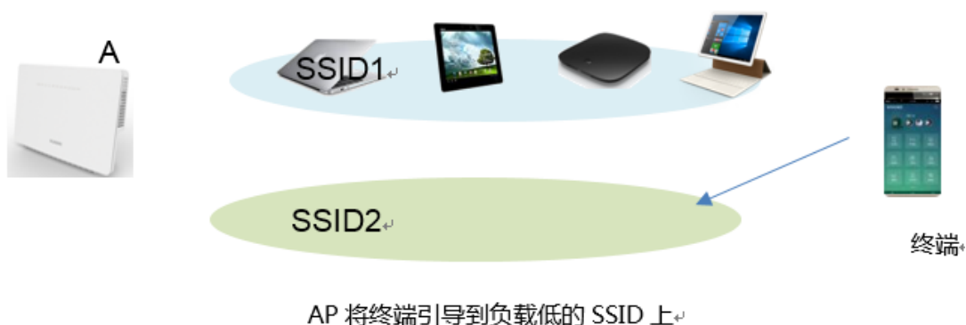
图4-6 SSID Steering 工作原理示意图
