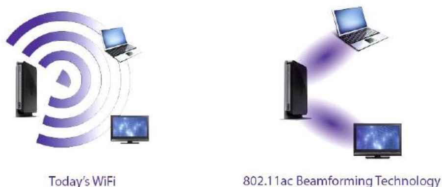
图4-9 Beamforming 工作原理示意图
